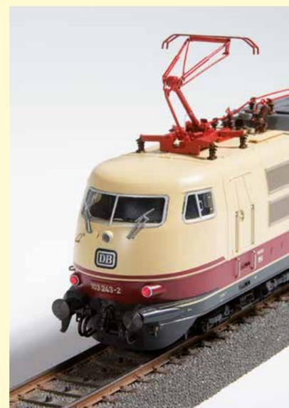
Der Lokführer wechselt seine aufrechte Position mit der Fahrtrichtung, kann aber, beispielsweise in Pausen, auch beidseitig abgesenkt werden.
