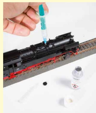
Gut 1 ml (mitgeliefertes) Öl in den Tank unter dem ersten Sandkasten gefüllt sorgt für einen optimalen Rauchausstoß.
