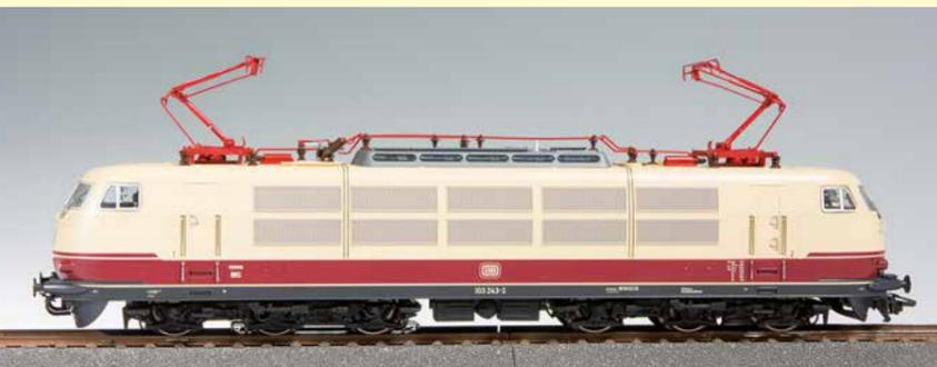
Nach dem Auspacken werden beide Stromabnehmer vorsichtig entriegelt und ausgefahren. Die weitere Steuerung erfolgt dann über die Zentrale.
