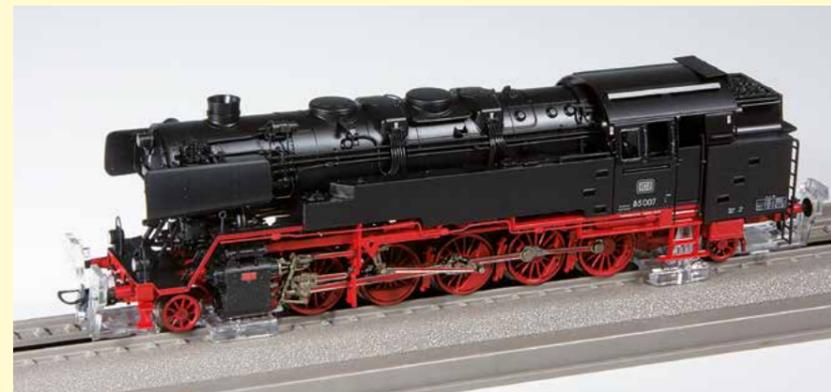
Die Lok ist nicht verschraubt. Flexible Klammern halten sie an den Puffern.
