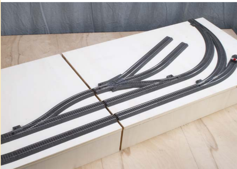
Wenn die Teile zusammengeschoben werden, rasten die Gleise ein und bilden eine sichere elektrische Verbindung. So ist die Anlage erweiterbar.
