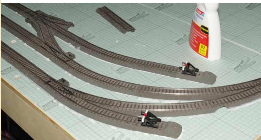
Das Befestigen der Gleise erfolgt schließlich durch Verkleben mit Weißleim wie Ponal. So lassen sie sich auch noch etwas später leicht korrigieren.
