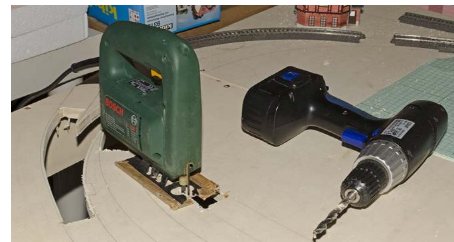
Mit Hilfe einer Stichsäge schneidet man unter Beachtung eines Kleberandes das Material unterhalb der Weichen großzügig aus.
