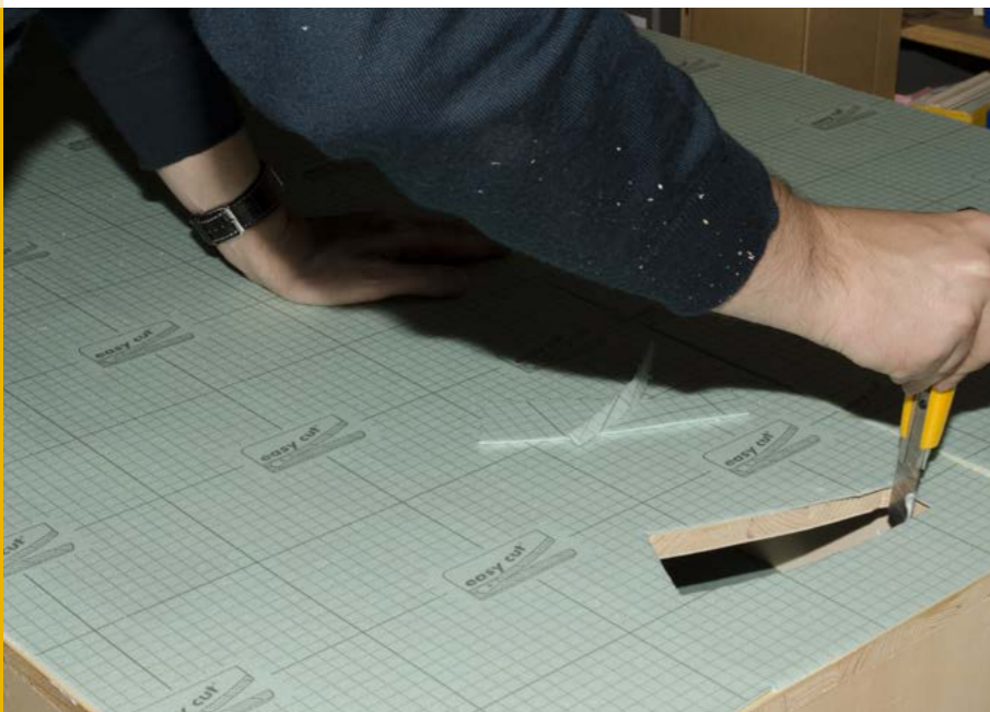
Zur Schalldämmung empfiehlt sich eine dünne Lage Styrodur, die vollflächig verklebt wird. Die Weichenöffnungen werden ausgeschnitten.
