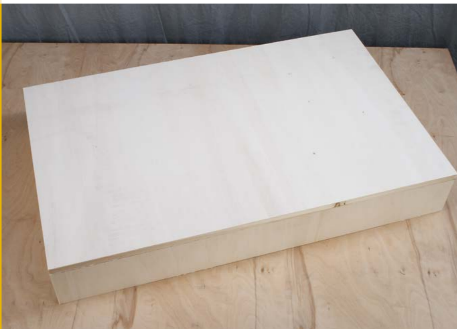
Anstatt auf einer unhandlichen Platte entsteht die erste Kleinanlage auf einem Unterbau aus vier verschraubbaren Kästen aus Tischlerplatten.
