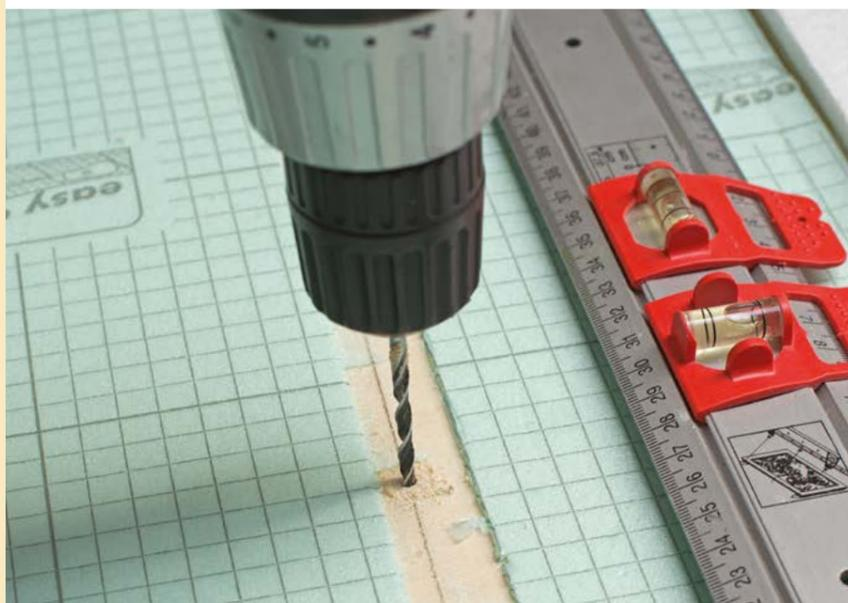
**Zum Befestigen der Hintergrundplatte wird die Anlagengrundplatte in gleichmäßigen Abständen von 10 bis 15 cm mit einem 3-mm-Bohrer vorgebohrt.**
