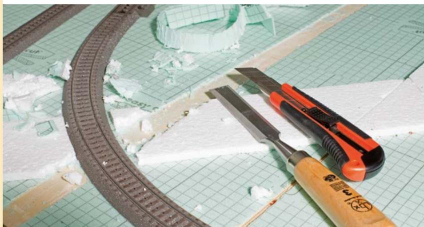
**Mit Bastelmesser und scharfem Stechbeitel wird entlang des zu setzenden Hintergrundes die Grundplatte wieder freigelegt.**
