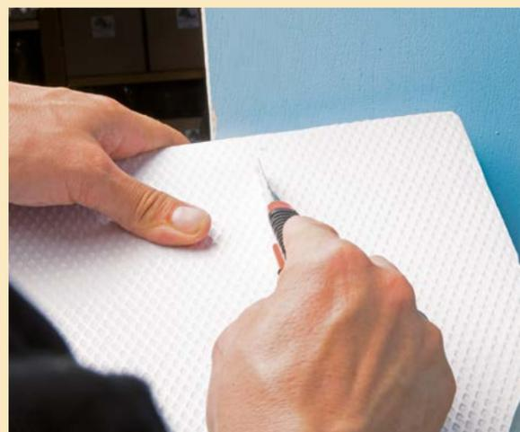
**Etwas mehr Stabilität und Festigkeit garantiert der Einsatz von Styrodur. Dieses Material lässt sich auch sehr gut mit einem Bastelmesser schneiden, etwa wie hier exakt entlang der vorderen Anlagenkante.**
